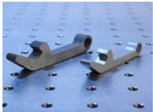
Binder Jetting (links: Grünling, rechts: fertiges Bauteil)
